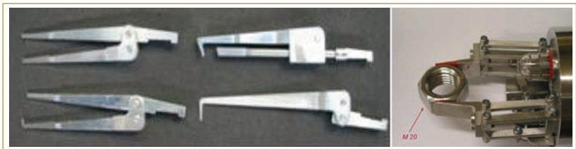
Figura 4: Varias pinzas y garras para recoger piezas sueltas.
