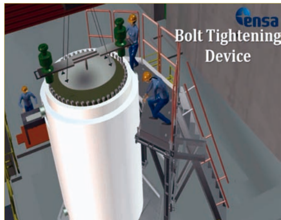
Figura 4: Manejo del contenedor ENUN 52B con el yugo de elevación. Figura 5: Operación de apriete de pernos en contenedor ENUN.
