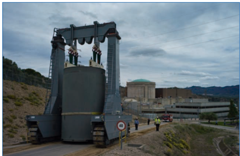
Foto 3. El Crawler inicia la subida desde la salida del doble vallado hacia el ATI llevando consigo un HI-STORM conteniendo una MPC llena con combustible irradiado. Para reducir al máximo el impacto sobre los viales de las más de 170 Tm del contenedor y de las más de 60 adicionales del propio vehículo se esparce arena (o goma troceada) a lo largo del recorrido.
