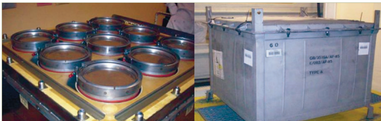
Imagen 1. Contenedor modelo 3516 para el suministro de UO_2 desde SFL.
