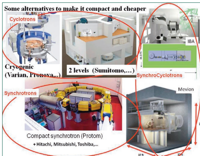
Figura 10. Sistemas compactos de protonterapia, usando distintos tipos de aceleradores (ciclotrones, sincrotrones y sincrociclotrones) propuestos por distintos fabricantes.
