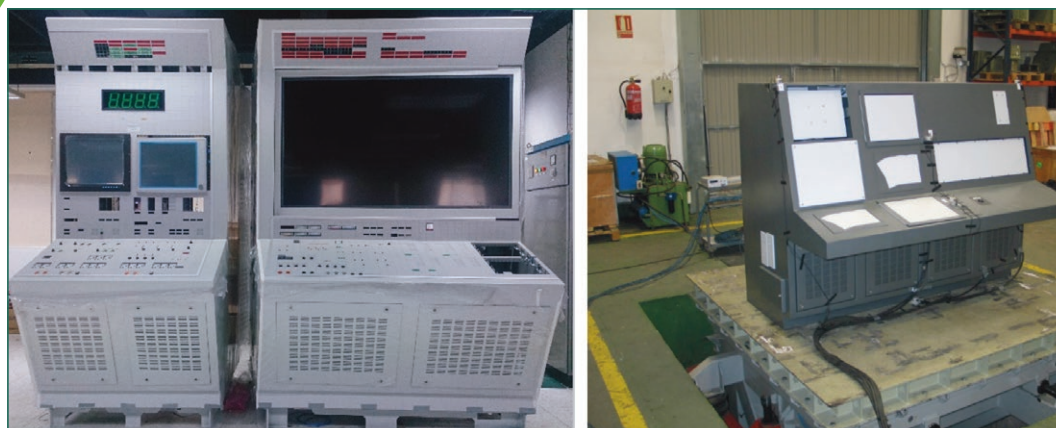
Figura 7. Fotos de pruebas de dedicación de instrumentos de y cualificación sísmica de los paneles de Yangjiang (izquierda) y Fuqing (derecha).
