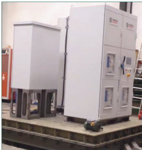
Figura 6. Realización de los ensayos en mesa vibratoria de los cuadros eléctricos de los generadores Diésel.
