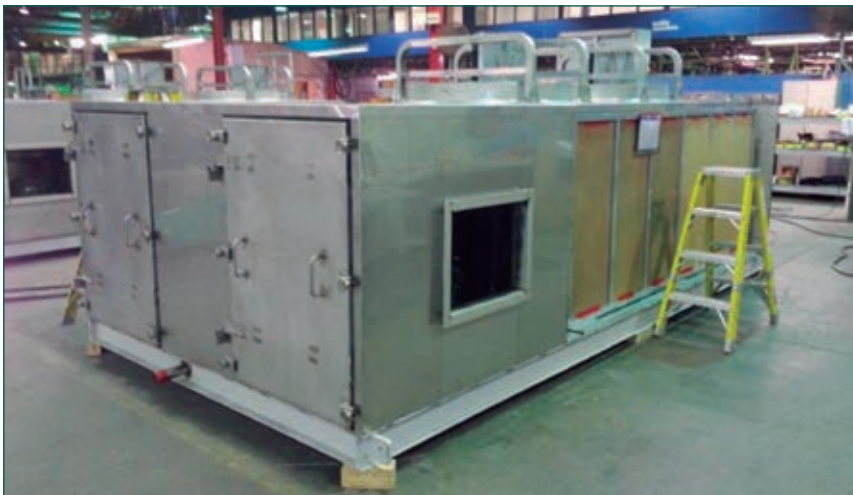
Imagen 18. Nuevas unidades de refrigeración.
