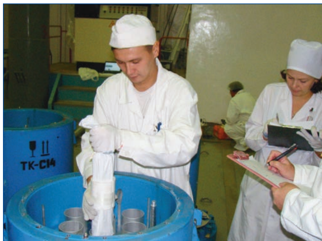
Carga de elementos combustibles frescos de HEU tipo VVR-TS en el contenedor de transporte TK-S16 (© S. Tozser/IAEA).
