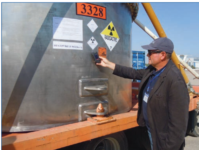
Medición de la tasa de dosis en la superficie de un contenedor de transporte cargado con combustible gastado de HEU.
