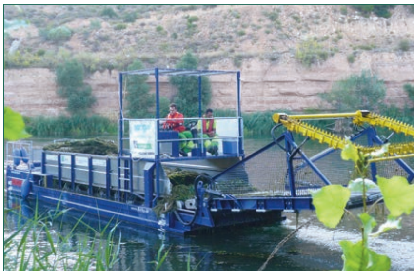
Figura 4. Embarcación con el mecanismo de siega izado. Se aprecia el contenedor de acopio de materia vegetal.
