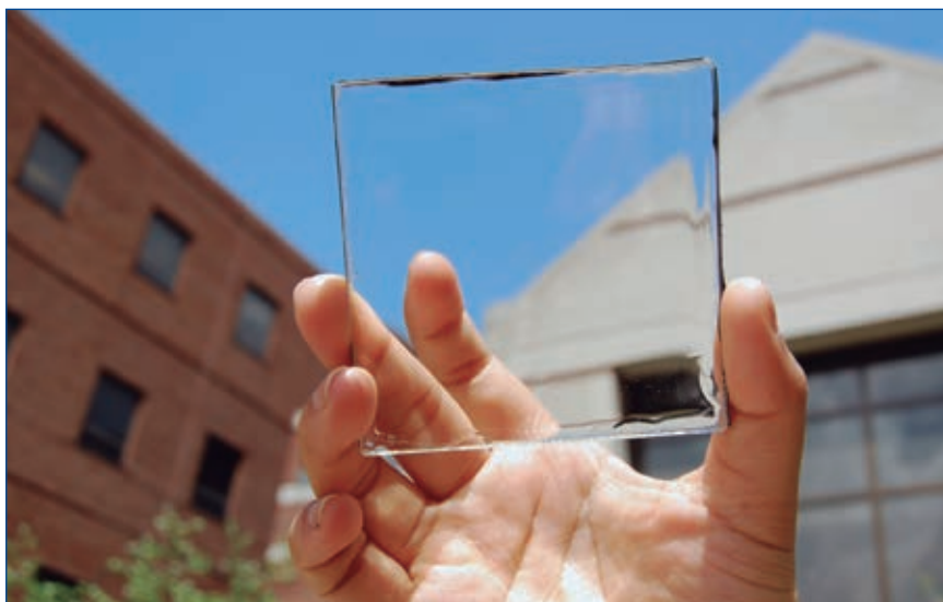
Figura 1. Prototipo de placa fotovoltaica transparente desarrollado por expertos de la Universidad Estatal de Michigan (EE.UU). Fuente: Michigan State University. Photo by Yimu Zhao.
