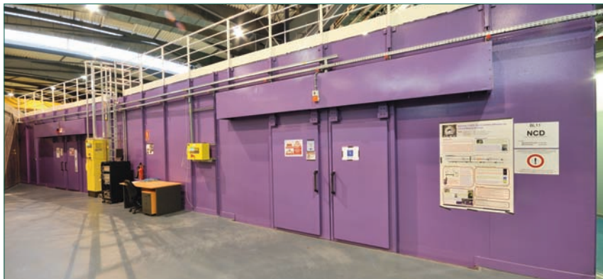
Figura 7. Vista panorámica de las cabinas de blindaje de la línea BL11-NCD de ALBA.
