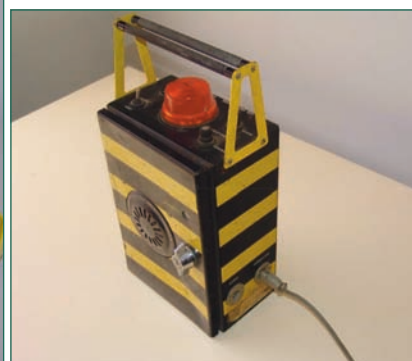
Baliza gamma ambiental con alarma visual y sonora.
