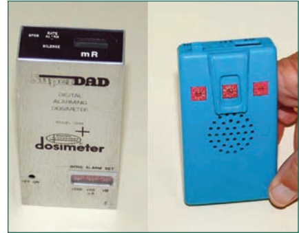
Dosímetros electrónicos de lectura directa con alarma.
