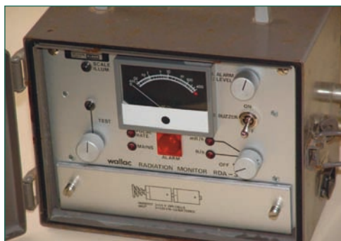
Unidad lectora del monitor de radiación con sonda GM para tasa de exposición con nivel de alarma.
