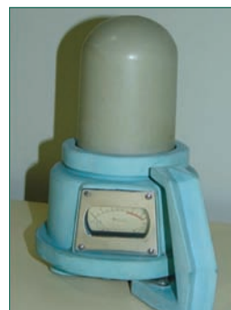
Escala de recuento de impulsos y unidad de cronometraje, modelo JEN.
