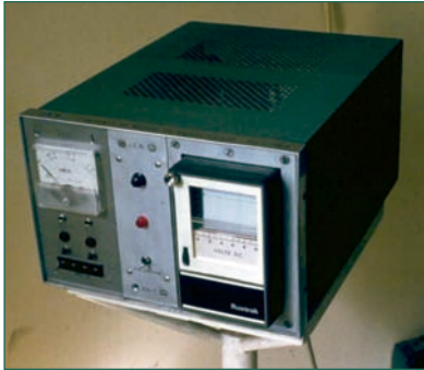
Monitor de radiación ambiental, modelo JEN, para tasa de exposición con registro.
