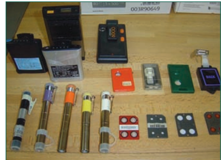
Dosímetros personales (estilodosímetros, TDL, y electrónicos de lectura directa con alarma).
