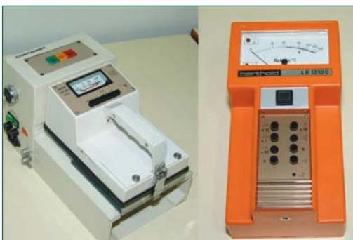
Detectores portátiles de contaminación con sonda proporcional de flujo de gas.
