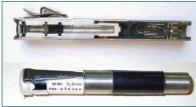
Dosímetro de lectura directa (electroscopio con cámara de ionización).
