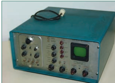
Cámara de ionización portátil climatizada de alto rango.
