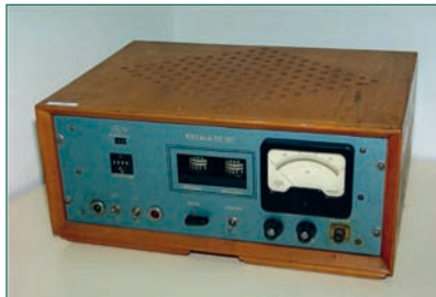
Monitor con sonda GM para beta débiles para chequeo de contaminación de manos extensible para chequeo corporal a la salida de zona controlada.
