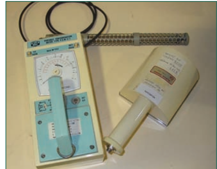
Detector portátil para contaminación \alpha con sonda Sz de centelleo.
