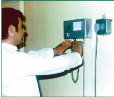
Monitor con sonda GM para beta débiles para chequeo de contaminación de manos extensible para chequeo corporal a la salida de zona controlada.
