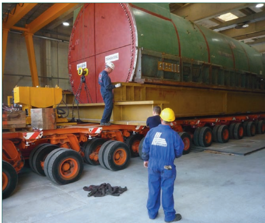
Llegada del estátor de repuesto a la nave n°6.
