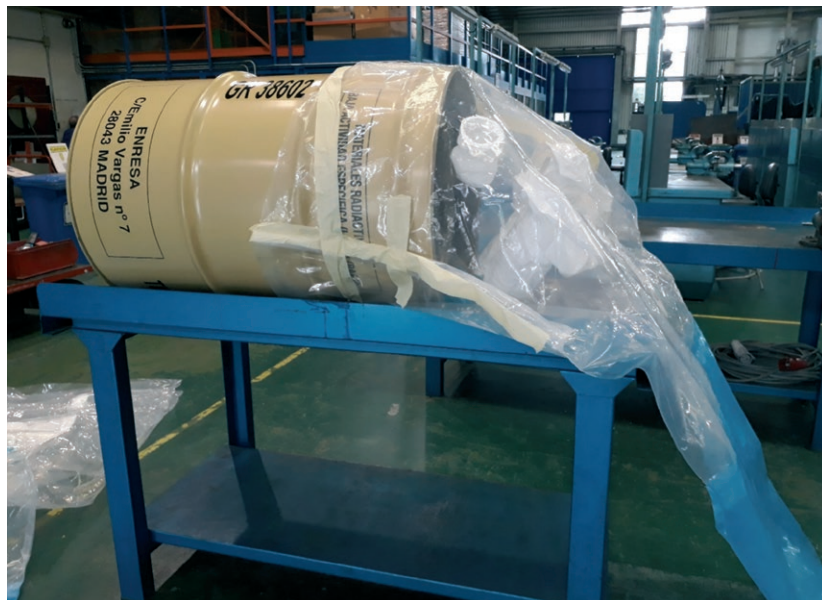
Prueba de viabilidad del uso de la bolsa guante para inspeccionar bidones.
