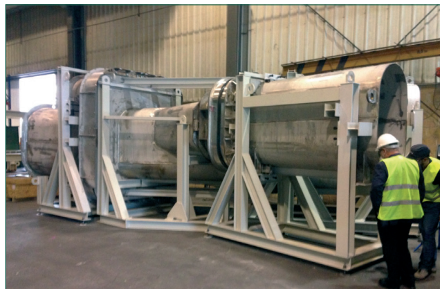
Figura 9. Maqueta 1:1 de puerto ecuatorial HNB-DNB.
