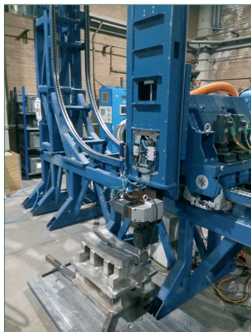
Figura 17. Sistema de mecanizado en sectores para el resanado.
