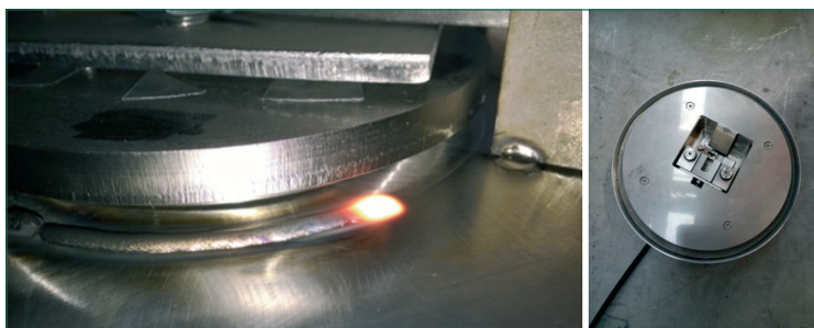
Figura 16. Sistema de gas de respaldo en biscuit.
