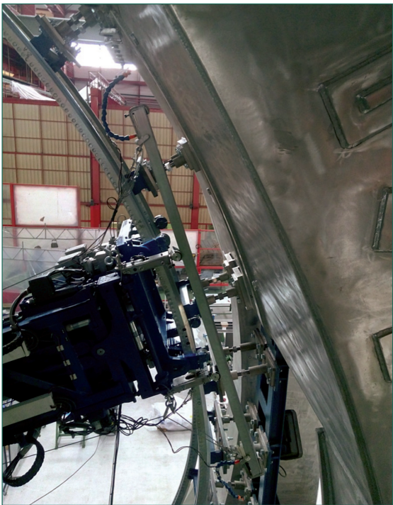
Figura 12. Sistema de posicionado de SP en sectores.
