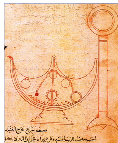
Figura 4. Dibujo de la lámpara auto relleable del Libro de Mecanismos Ingeniosos de los hermanos Banu Musa.
